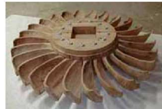
Le moulin du Soulier était équipé d'une roue horizontale dite « à cuillères »
